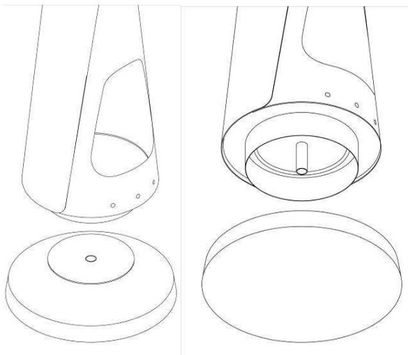
3. Montaggio del maniglione per la rotazione della colonna.
