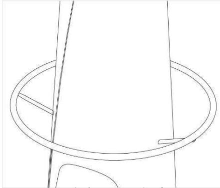
4. Assemblare il vano combustibile collegando le due semiparti in materiale refrattario:
