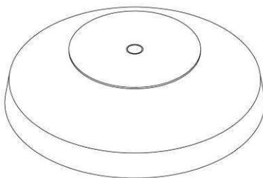
2. Inserimento della colonna verticale nell'apposito foro predisposto nel basamento, tale modalità di collegamento permette di avere la colonna rotante rispetto al basamento senza pericolo di ribaltamento.
