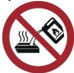
Do not pour fuel when the burner is hot
