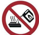
Do not pour fuel when the burner is hot
